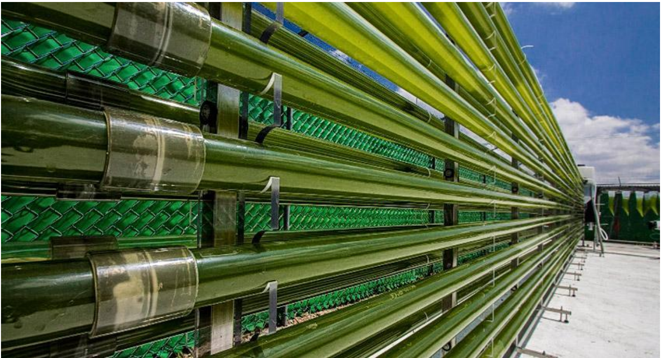
Imagen 5. Tubos donde crecen las microalgas. Fuente: Asociación Española del Bioetanol
